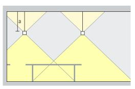
Una iluminación indirecta en techos claros aumenta el confort visual gracias a la reflexión difusa de la luz. Además, se incrementa la sensación de altura del espacio. A tal fin, la luminaria debería estar suspendida a una altura mínima de 0,5m.
