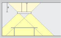
Una iluminación indirecta en techos claros aumenta el confort visual gracias a la reflexión difusa de la luz. Además, se incrementa la sensación de altura del espacio. A tal fin, la luminaria debería estar suspendida a una altura mínima de
