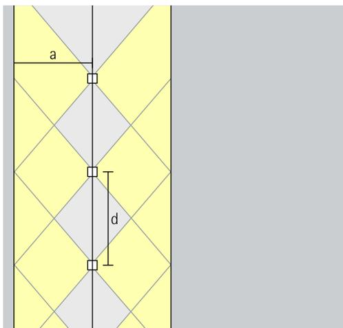
Para lograr una buena uniformidad longitudinal, la interdistancia de luminarias (d) de los bañadores de pared con lente Compar puede equivaler a hasta 1,3 veces la distancia a la pared (a).
