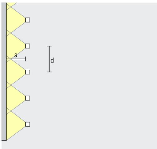
Para obtener una buena uniformidad en sentido longitudinal, la interdistancia de luminarias (d) de los bañadores de pared Beamer puede equivaler a hasta 1,5 veces la distancia a la pared (a).
