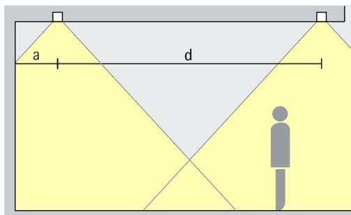
La distance au mur recommandée correspond à la moitié de l'entraxe entre les appareils d'éclairage.
