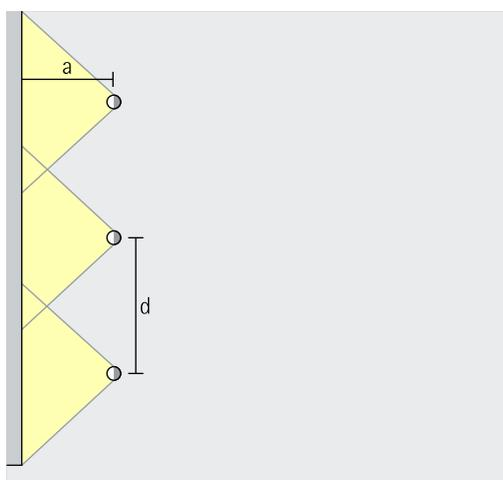
Pour une bonne homogénéité dans la longueur, l'entraxe ( $d$ ) entre les appareils à faisceau mural à lentille Quintessence peut correspondre jusqu'à 1,3 fois la distance ( $a$ ) au mur.
