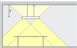
L'éclairage indirect sur des plafonds clairs améliore le confort visuel par la réflexion diffuse de la lumière. L'espace semble également plus haut. L'appareil d'éclairage devrait pour cela être suspendu à au moins
