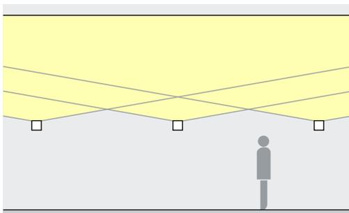
Pour une bonne homogénéité dans la longueur, l'entraxe (d) entre deux appareils d'éclairage des façades Focalflood peut s'élever à 1m.
