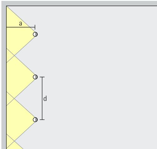
Pour obtenir une bonne uniformité longitudinale l'entraxe (d) des appareils d'éclairage à faisceau mural à lentille Eclipse peut s'élever jusqu'à 1,2 fois la distance jusqu'au mur (a).
