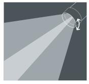
**Proyectores de enfoque** Mediante un simple giro de la lente, se puede ajustar sin escalonamiento el diámetro del haz de luz desde spot (15°) hasta wide flood (65°). Los proyectores de enfoque están especialmente indicados para la iluminación de zonas con objetos expuestos y productos cambiantes.
