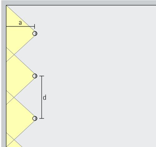
Para lograr una buena uniformidad longitudinal, la interdistancia de luminarias (d) de los bañadores de pared con lente Pantrac puede equivaler a hasta 1,5 veces la distancia a la pared (a).
