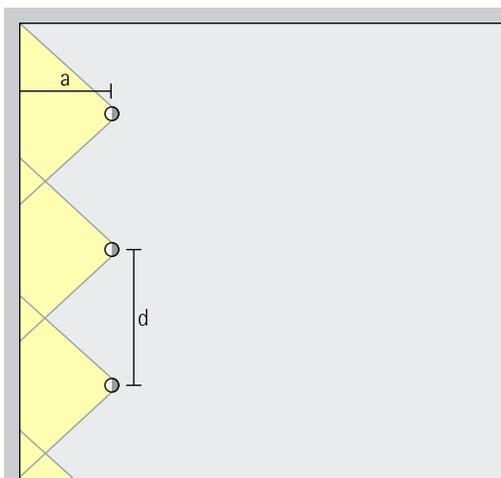
Para lograr una buena uniformidad longitudinal, la interdistancia de luminarias ( $d$ ) de los bañadores de pared con lente Opton puede equivaler a hasta 1,2 veces la distancia a la pared ( $a$ ).
