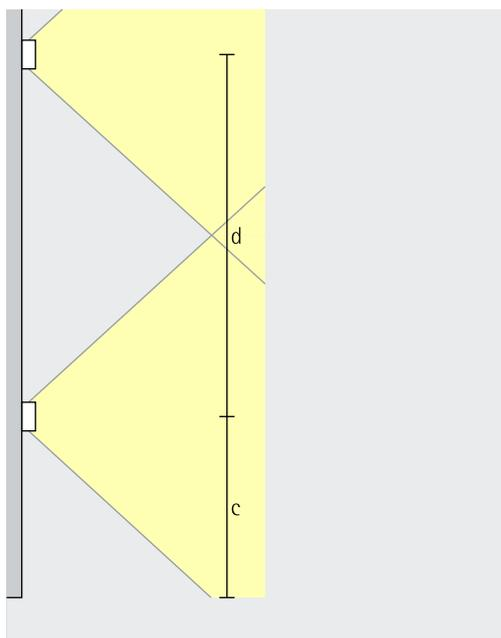
Con una distribución luminosa de haz extensivo, la interdistancia de luminarias (d) puede ser de hasta 4 veces la distancia hasta el techo (a).
