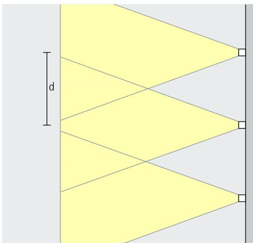
Para lograr un bañado de suelos uniforme, la interdistancia de luminarias (d) puede ser de hasta 2 veces la altura de montaje (h). Si se utiliza la luminaria para la orientación visual, la interdistancia de luminarias puede ser de hasta 10 veces la altura de montaje.
