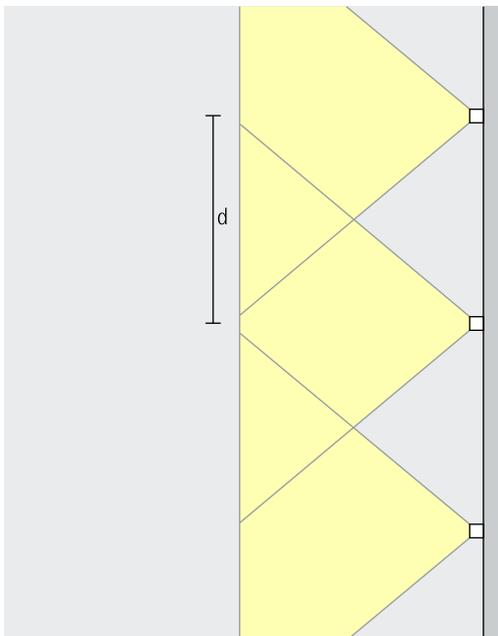
Para lograr un bañado de suelos uniforme, la interdistancia de luminarias (d) puede ser de hasta 2 veces la altura de montaje (h). Si se utiliza la luminaria para la orientación visual, la interdistancia de luminarias puede ser de hasta 10 veces la altura de montaje.
