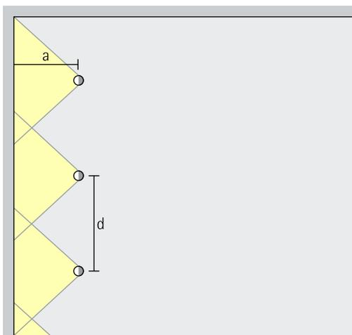
Para una iluminación vertical uniforme, la distancia a la pared ( $a$ ) de los bañadores de pared con lente Gimbal debería ser de aproximadamente un tercio de la altura del techo ( $h$ ). De ello se deriva un ángulo de inclinación ( $\alpha$ ) de aprox. 35°.
