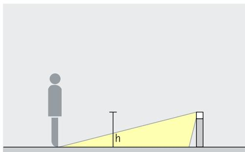
Castor Pollerleuchten mit 180° breit abstrahlender Lichtverteilung ( $h \geq 800$  mm) ermöglichen eine gleichmäßige Wegebeleuchtung mit Leuchtenabständen (d) von bis zu 8m. Zur optischen Führung können noch weitere Abstände gewählt werden.
